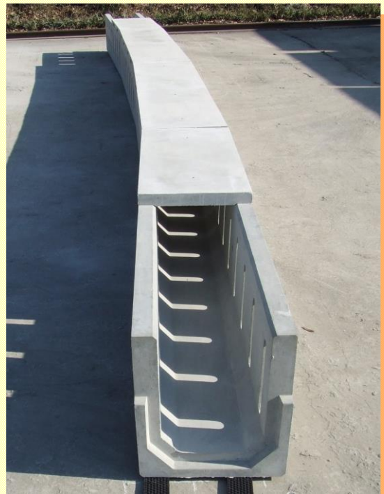
写真は、ジョイント部の隙間を20mm開けたときのカーブ付け状況 (R = 50m 相当)
