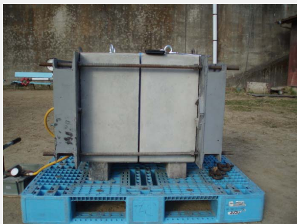
水密性試験 試験水圧0.1MPa
