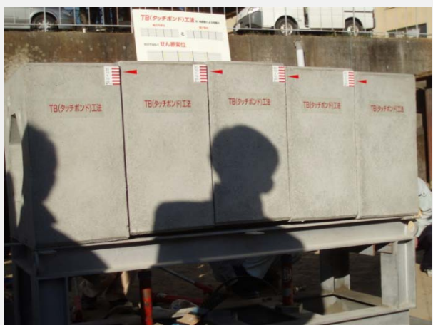
変位試験(せん断変位)
