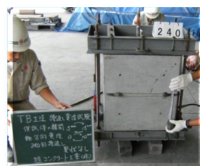
軸方向変位試験の状況 追随性を確認！はがれなし！
