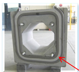
供試体の断面 (写真は 注入工法 )
